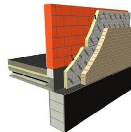
UTHERM wall est un panneau d'isolation thermique en mousse polyisocyanurate rigide, revêtu d'une multicouche composée de papier de kraft et des feuilles métalliques et étanche au gaz.
